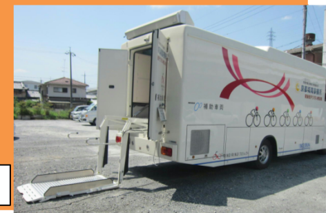
車いす昇降用リフト
